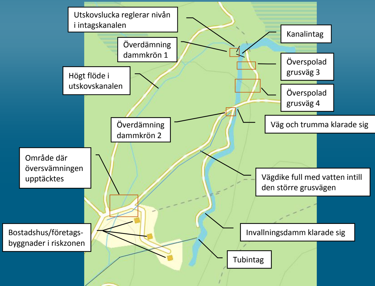
Översikt - Kanalintag till kraftstation
